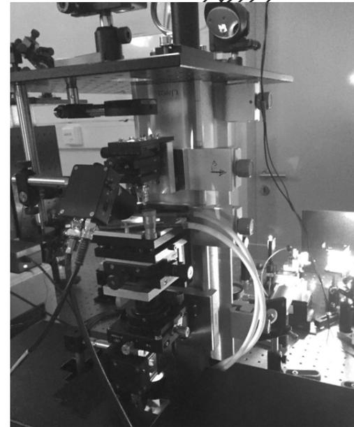
Durch die gezielte Beleuchtung von halbseitig beschichteten Teilchen durch einen grünen Laser lässt sich das kooperative Verhalten der lasergesteuerten Mikroschwimmer kontrollieren.
