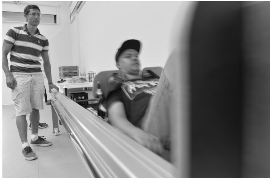
Sprungschlitten: Ein Sprungschlitten für den Welt- raum. Er wurde als Trainingsgerät für Astronauten entwickelt und ermöglicht ein Sprungtraining in Schwerelosigkeit.
